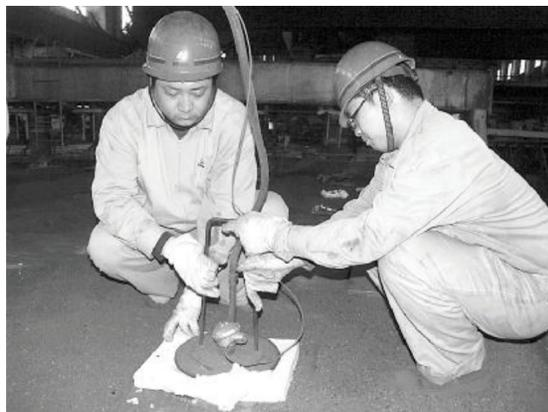
4月下旬,碳素厂焙烧二车间调温工段员工对2个燃烧系统的枪座、测温测压架126个密封点的密封形式进行了小小的改革。新的密封形式减少了冷空气的进入量,有效降低了天然气的消耗。
